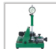
Prüfung der Genauigkeit von Bohrungsmessgeräten (Messbereich 6-450mm)
