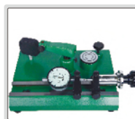
Prüfung der Genauigkeit von Messuhren (Messbereich 0-25mm)
