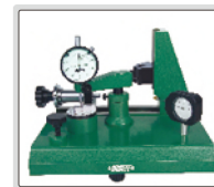
Prüfung des Einflusses der Lateralkraft auf die Genauigkeit von Messuhren (halbrundes Endmaß wird benötigt)
