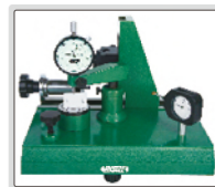
Prüfung der Wiederholbarkeit von Messuhren
