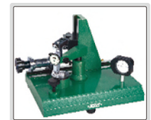
Prüfung des Einflusses der Lateralkraft auf die Genauigkeit von Fühlhebelmessgeräten (halbrundes Endmaß wird benötigt)
