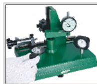
Messkraftprüfung an Messuhren
