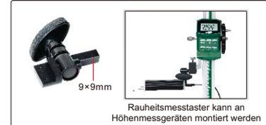
Rauheitsmesstaster kann an Höhenmessgeräten montiert werden
